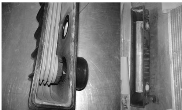
Figura 10. Imagen comparativa de la zona de intercambio del radiador A(izquierda) y radiador B(derecha).
