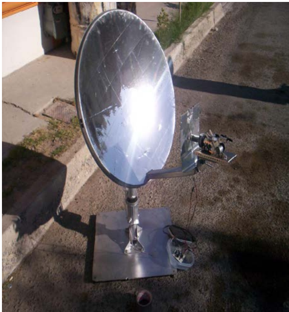
Figura 7.- Concentrador solar con motor Stirling.
