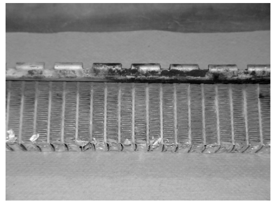
Figura 6. Daño sufrido en el cuerpo del radiador o emparrillado A.
