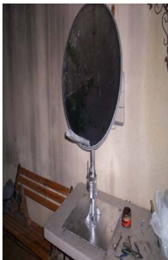
Figura 5.- Sistema de engranaje con el disco parabólico instalado.
