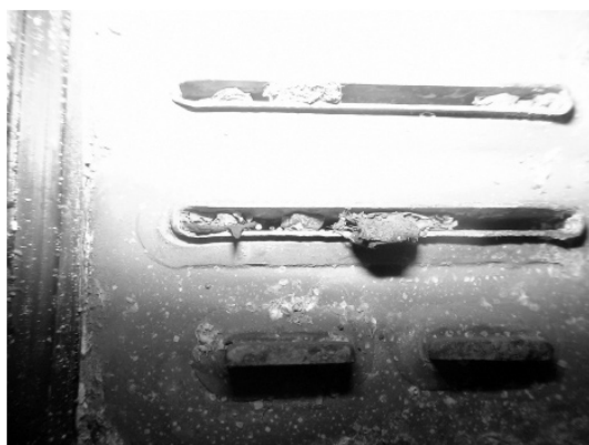
Figura 9. Imagen de la zona central de emparrillado del radiador tipo B en la que se puede apreciar el taponamiento del mismo debido a sales y óxido de hierro.
