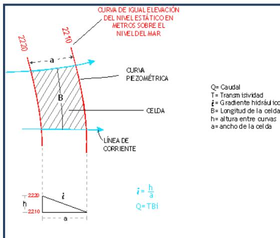
En esta configuración se seleccionaron canales o celdas de flujo y se aplicó la Ley de Darcy para calcular el caudal “Q” que recarga al acuífero. La recarga total por flujo horizontal es la suma de los
