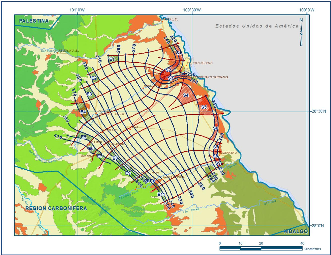
Figura 5. Elevación del nivel estático en msnm (2011)
