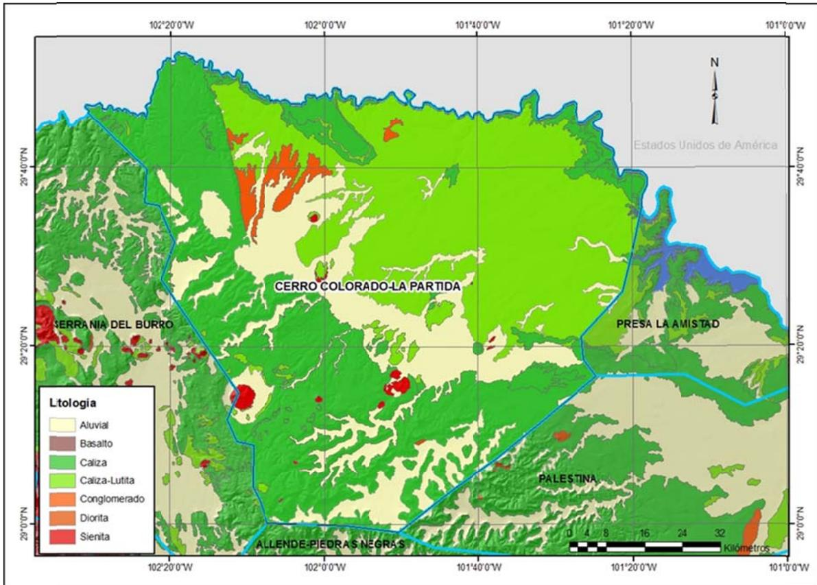
En la parte sur del acuífero afloran rocas calizas que conforman la Sierra del Burro con pendientes abruptas. De la parte central hacia el norte, hasta el Río Bravo, afloran rocas calcáreo-arcillosas que forman lomeríos suaves. El material aluvial se encuentra en el centro del acuífero. Existen algunos pequeños afloramientos de rocas ígneas intrusivas de composición intermedia, sienitas, que forman el Cerro Colorado.
