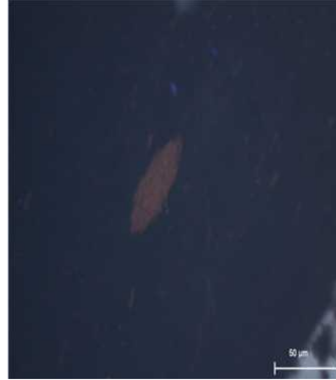
Manto 1 – Liptinita – Fm. Olmos, cercano a Las Esperanzas, Coah. (Luz de halógeno - fluorescencia, objetivo 50x inmersión de aceite).
